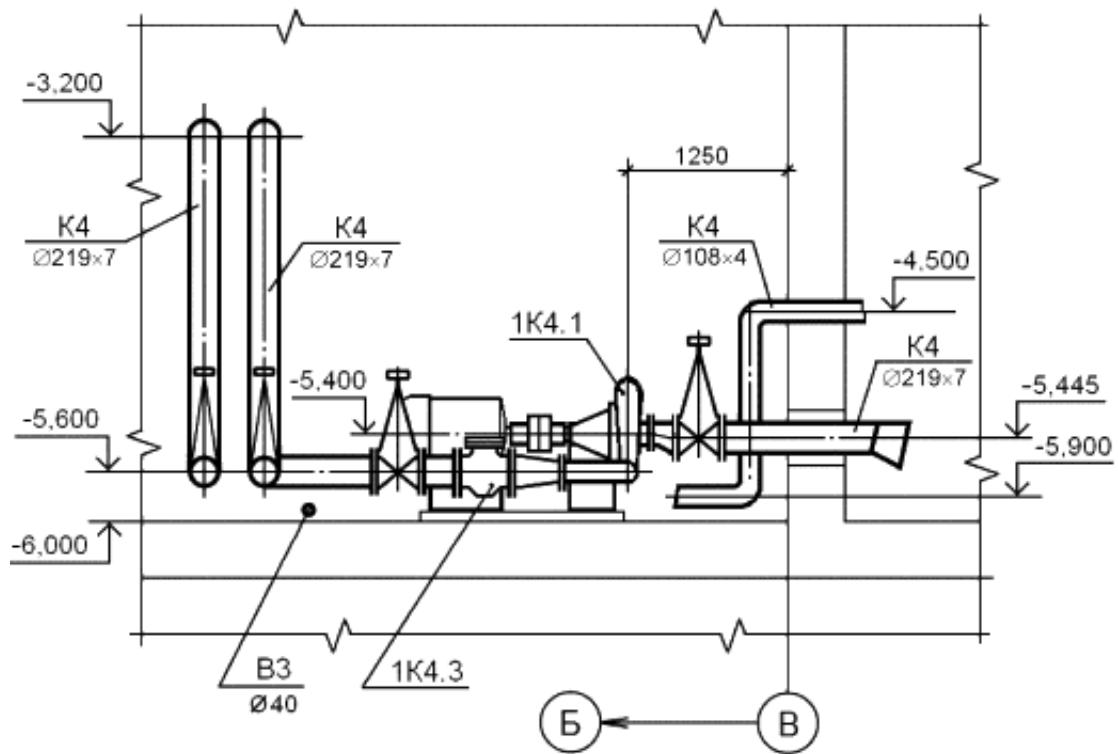
Рисунок В.1 - Пример выполнения плана установки системы канализации
