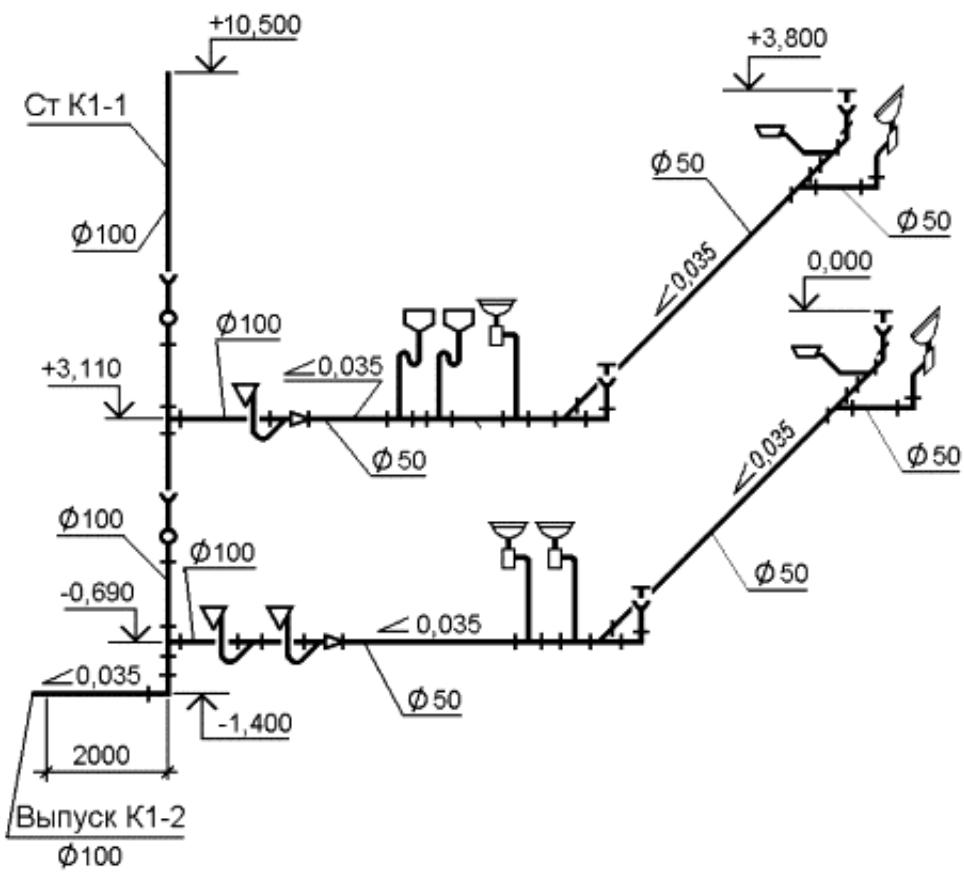
Рисунок Б.1 - Пример выполнения схемы системы водоснабжения
