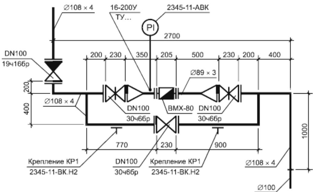
Рисунок Б.2 - Пример выполнения схем систем канализации
