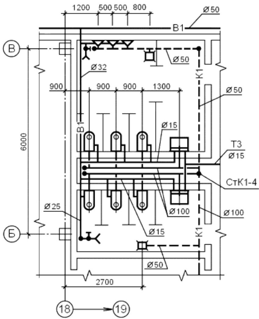
Рисунок А.2 - Пример выполнения плана системы дождевой канализации
