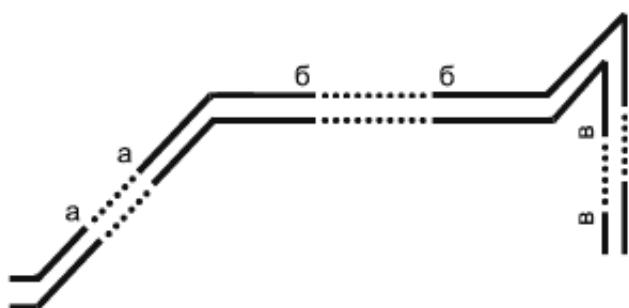
6.2.2 На схемах элементы систем, как правило, указывают условными графическими обозначениями. При необходимости отдельные элементы системы на схеме, выполняемой в аксонометрической проекции, изображают упрощенно в виде контурных очертаний.
