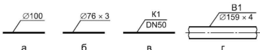
"(допускается условное обозначение "DN") в соответствии с рисунками 2а, 2в. При указании наружного диаметра и толщины стенки перед размерным числом наносят знак "
