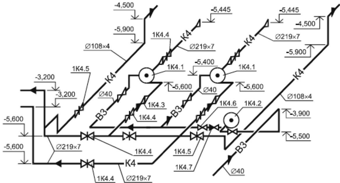
Рисунок В.2 - Пример выполнения разреза установки системы канализации
