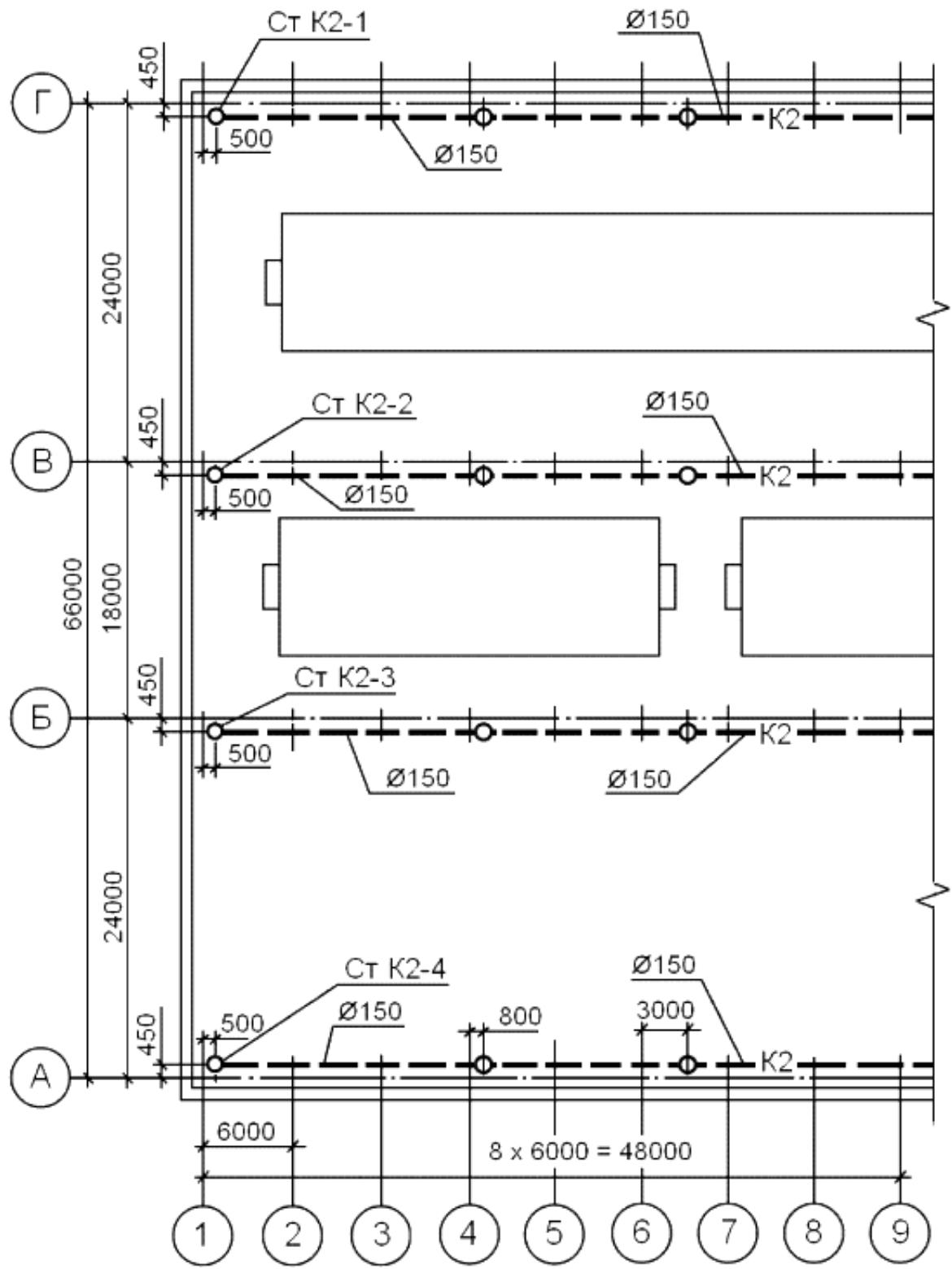
Рисунок А.1 - Пример выполнения плана систем водоснабжения и канализации
