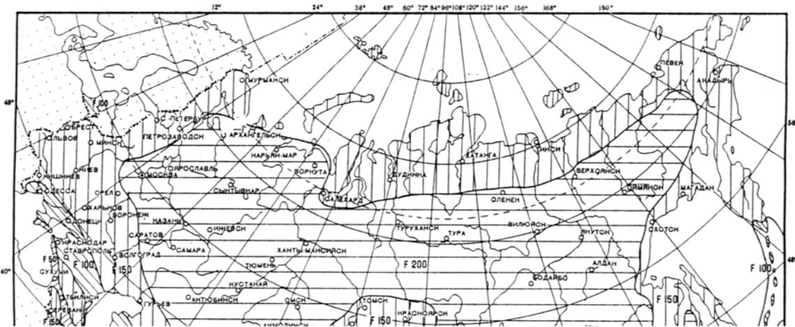
Рисунок 2 - Районирование территории СНГ по требуемой морозостойкости бетона для однослойных и верхнего слоя двухслойных покрытий
