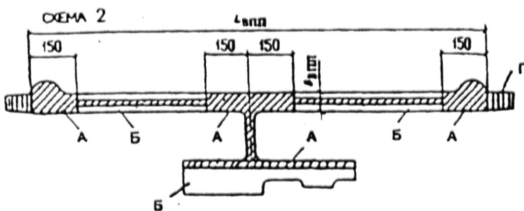
Рисунок 3 - Схемы деления покрытий аэродрома на группы участков:
